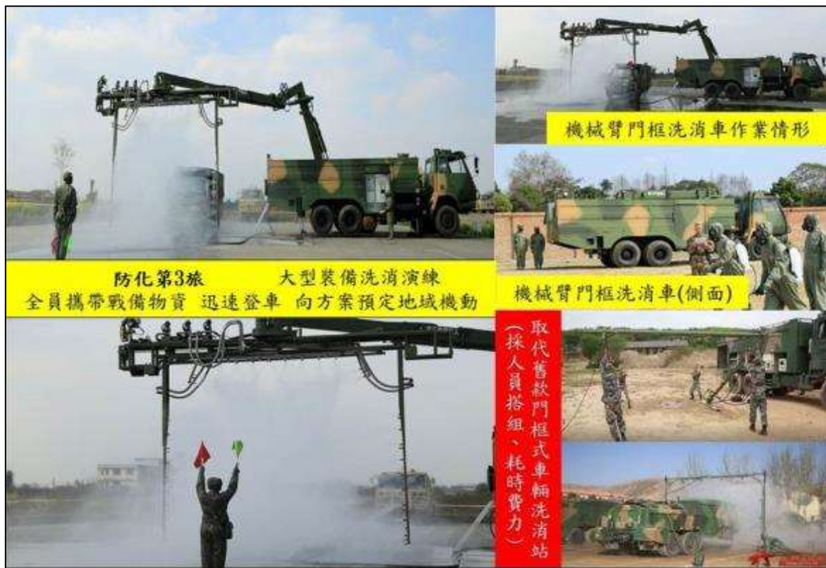
圖 28 共軍「龍門式洗消車」與「門框式車消站」
