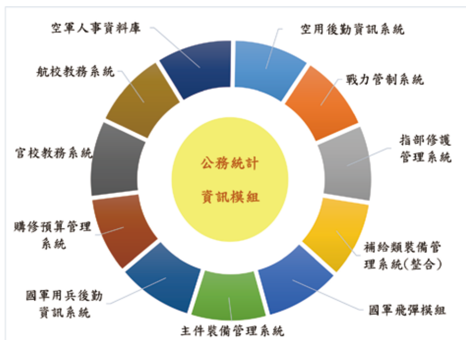
圖7 公務統計資訊模組介接系統架構圖
