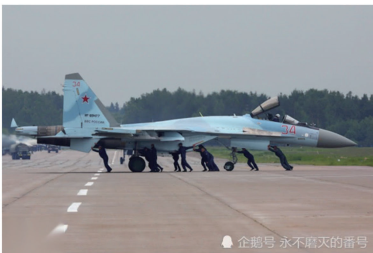
圖5 人力牽引作業
