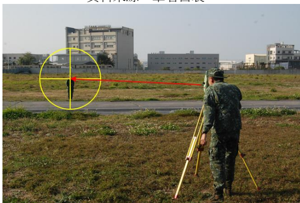
圖 35 測手指揮反射器手將反射器移動至測距經緯儀之視軸線上
