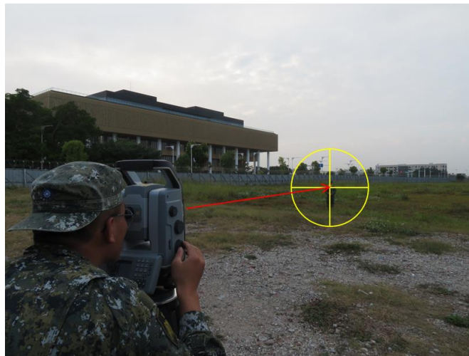
圖 54 測手指揮反射器手於望遠鏡十字線縱線上豎立反射器示意
