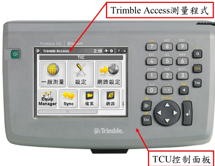
圖 41 「TCU 控制面板」與「Trimble Access 測量程式」
