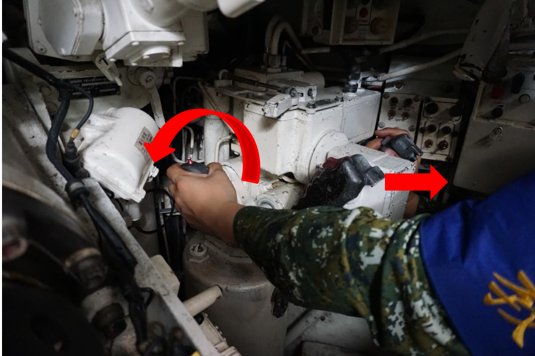
圖 33、射手動力 H 型握把向上，人力高、低握把向下
