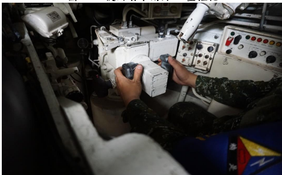
圖 30、使用射手動力 H 型握把
