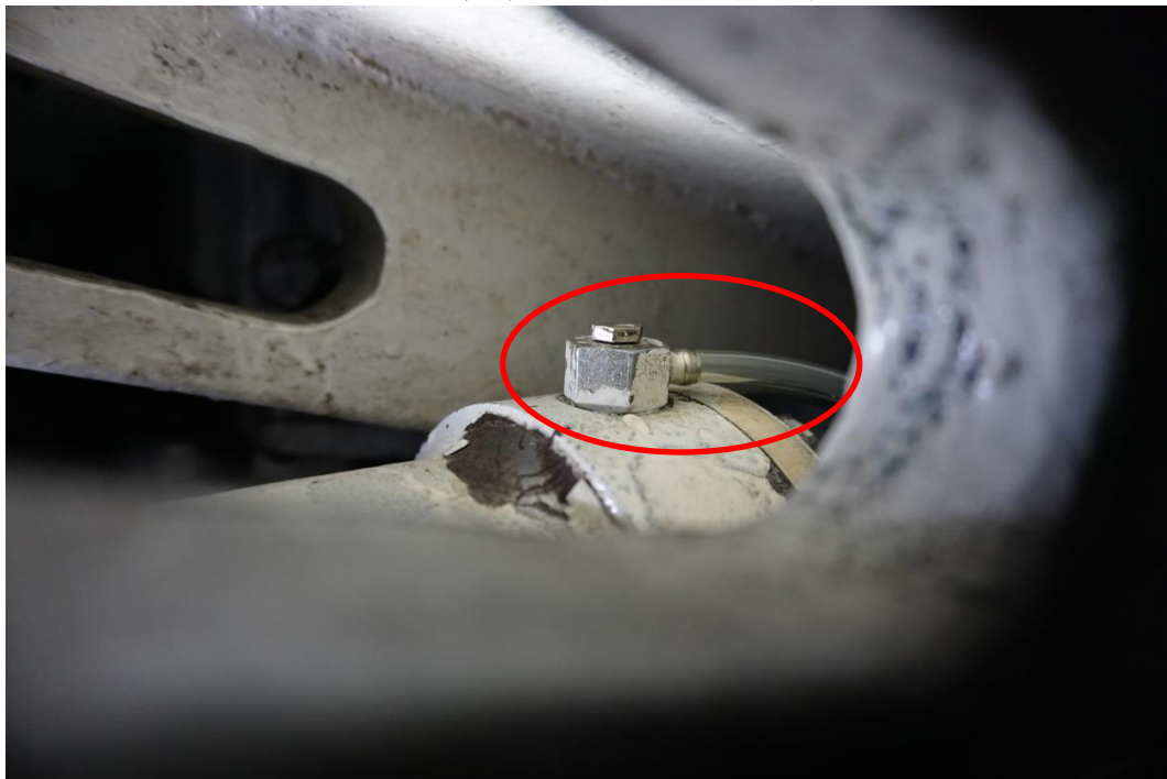
圖 32、連接軟管至高、低機後排放孔位
