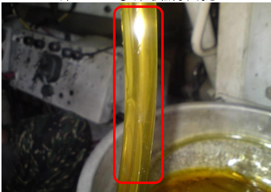
圖 19、M1 透明軟管無夾帶氣泡
