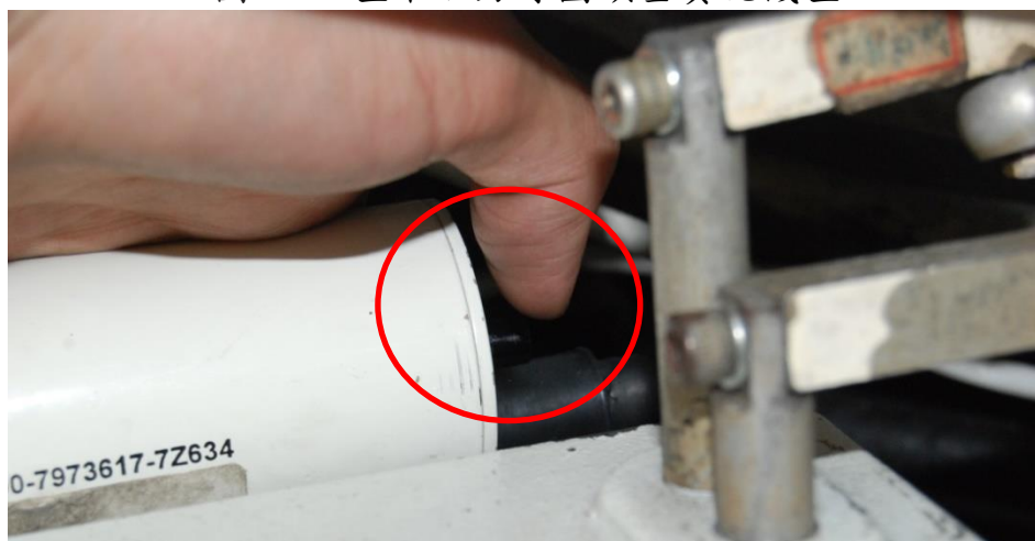
圖 29、壓下磁力線圈頂塞實施洩壓
