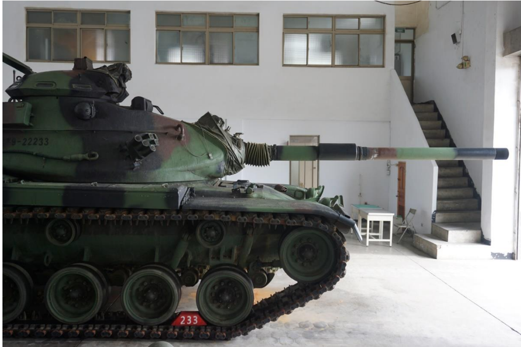
圖 31、操縱戰車砲置於水平位置
