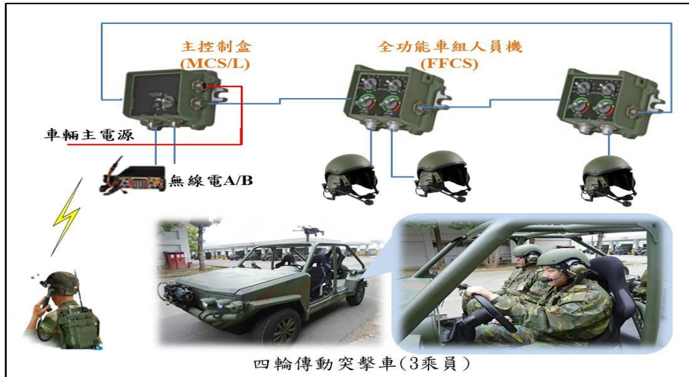
圖4 ROVIS LV2車內通話系統架構圖
