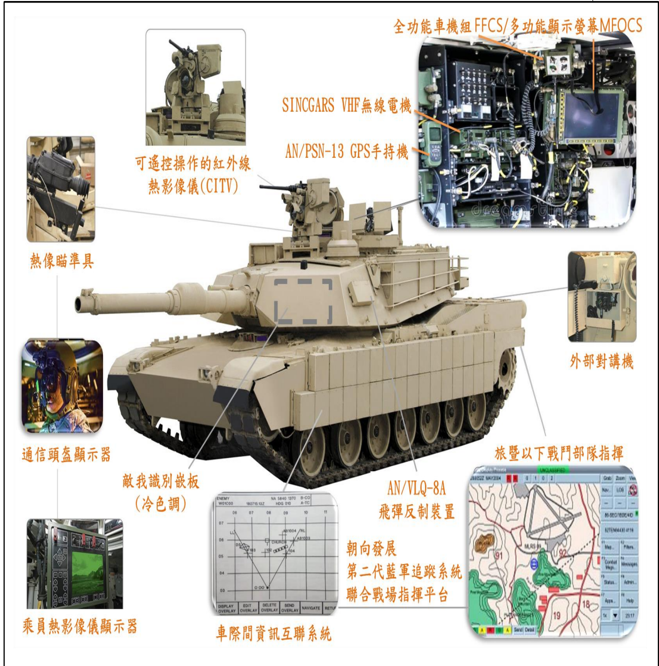
圖11 M1系列戰車車內通話系統結合通信指管架構圖(以M1A2 SEP V3為例)
