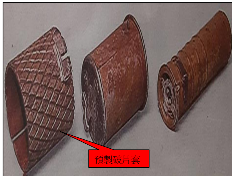
圖二十：蘇聯 RGD-33 有柄型手榴彈預製破片套
