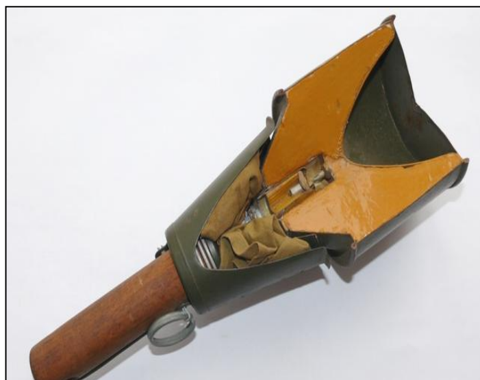
圖十三：蘇聯 RPG-43 式反戰車手榴彈截面圖
