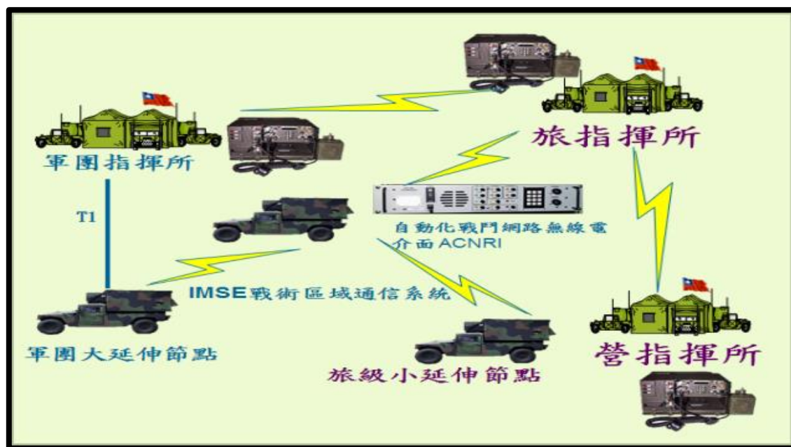
圖 19、戰術區域通信系統(陸區)運用示意圖
