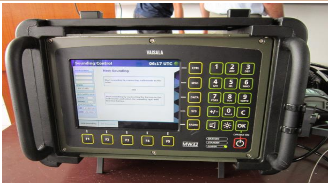
圖 3 MW - 32 砲兵彈道氣象自動探測系統
