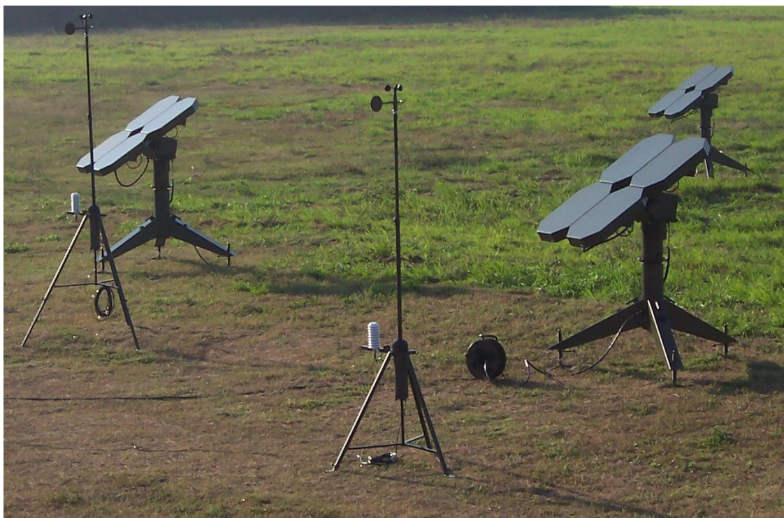
圖 2 RT - 20 無線電經緯儀架設示意圖
