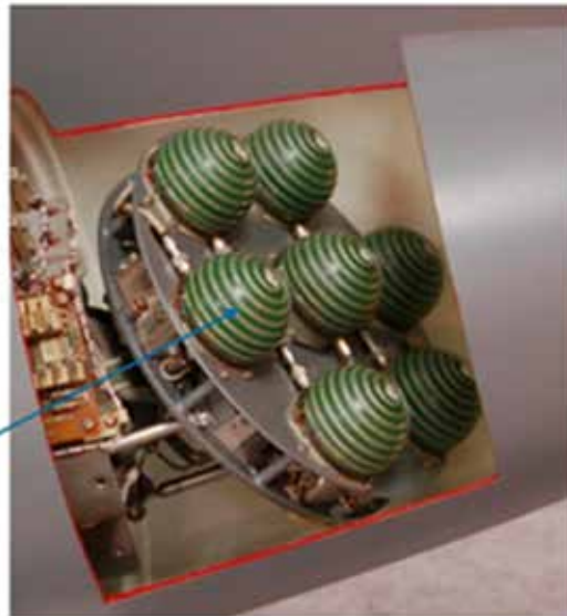
L-150系列的「平頂」半球狀螺旋天線示意。結合半球狀螺旋天線與平面螺旋天線的特點，頻率範圍1~18GHz。
