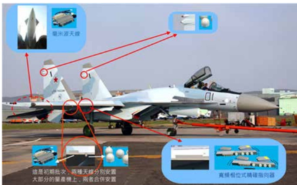
圖3 第一批Su-35S的L-150-35天線分佈。(圖片來源：KAAPO, TsKBA,作者；製圖：作者)
