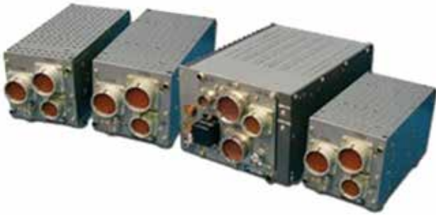
圖5：AUTs-30系列簡單的說是用來優化被動定位能力的運算裝置，當L-150搭配AUTs-30後就相當於被動射控雷達。圖為AUTs-30，Su-35用的是AUTs-30-03。(TsKBA)
