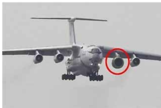
附圖六 大陸以渦扇-20裝備在IL-76運輸機展開測試已有多年
