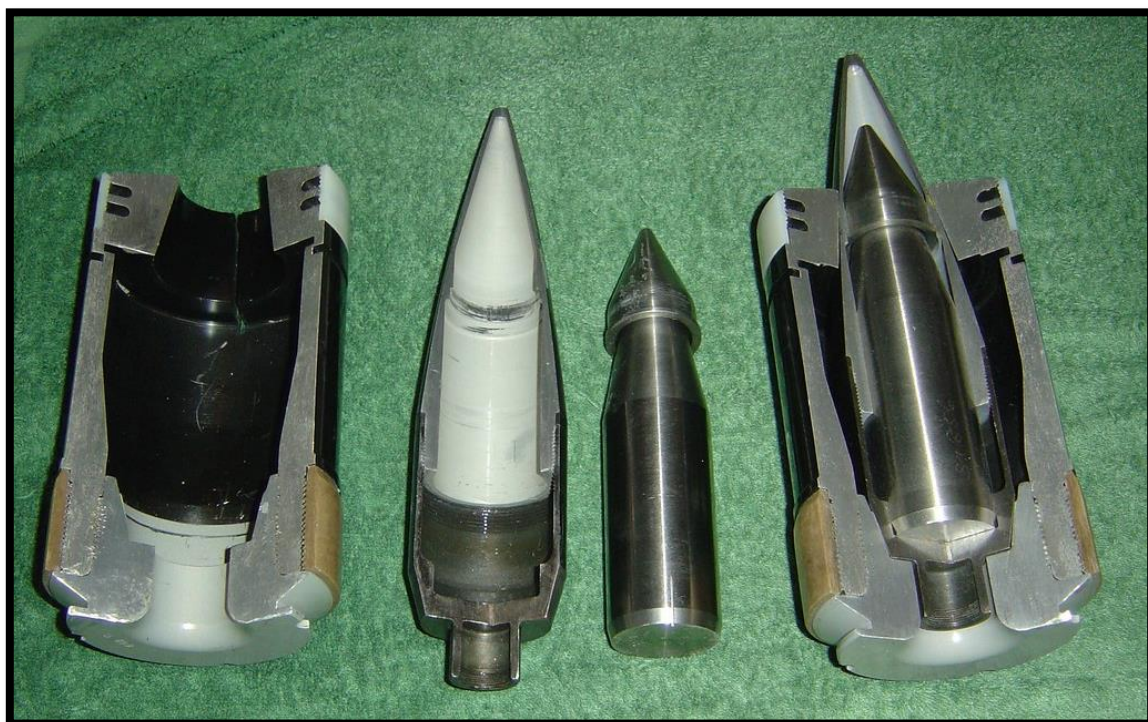
▲圖2、脫殼穿甲彈(Armour-Piercing Discarding Sabot, APDS)的出現，讓砲彈的穿透力有飛躍性的提升。在此技術穩定之後，脫殼穿甲彈基本上取代了所有的全口徑穿甲彈，並成為現代普及之尾翼穩脫殼穿甲彈(Armour-Piercing Fin-Stabilized Discarding-Sabot, APFSDS)的技術基礎，此圖為M392 脫殼穿甲彈。
