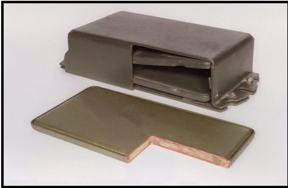
▲圖5、接觸一型爆炸反應裝甲(Kontakt 1 ERA)是俄國第一款服役且非常普及的戰車保護裝備，其單個反應裝甲內有兩角度不同的反應片，分別由2mm鋼板 + 7mm鈍性炸藥 + 2mm鋼板 8 所組成。一旦砲彈或射流貫穿鋼板觸發鈍性炸藥，鋼板將往兩向飛出，藉此達到針對彈頭或射流斜切，導致噴流不連續或彈頭折斷的作用。
