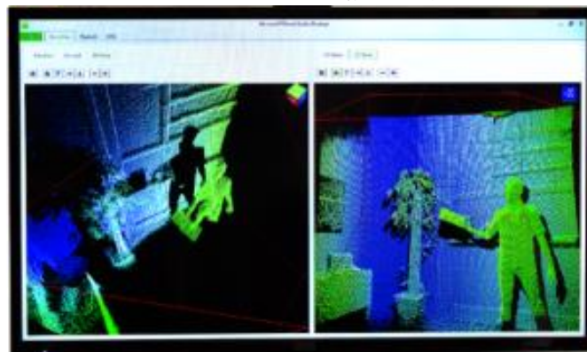
圖五 微軟Kinect 3D結構光深度示意圖
