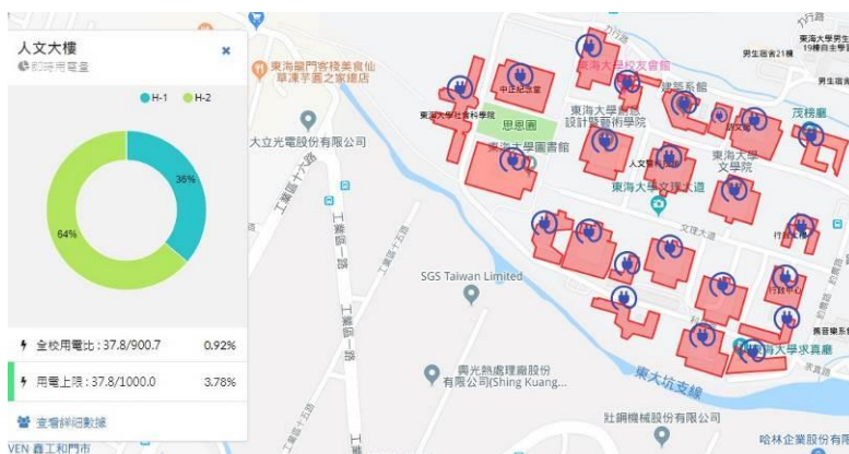
圖九 智慧電力監控系統
