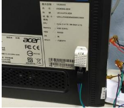
圖十八 溫濕度感測器安裝於主機位置圖
