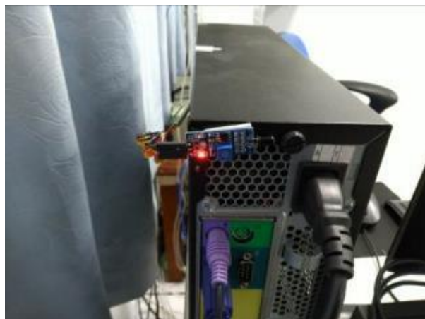
圖二十火焰感測器安裝於主機位置圖
