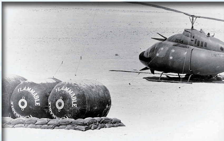
1990年11月10日，美國第18空降軍欺敵小組在沙烏地阿拉伯東部省分，於那瑞亞(An Nuariya)西北方45公里處執行的欺敵行動中，以圖中充氣式OH-58C奇歐瓦戰士直升機和充氣式油料補給設施，模仿前進油彈補給點。(Source: US Army/Randall R. Anderson)
