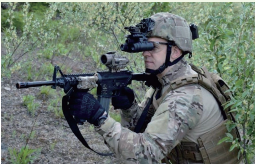
雙筒夜視鏡(圖中為L3-ENVG-B加強型雙筒夜視鏡)仍十分普遍。L3-ENVG-B夜視鏡將高效能白螢影像增強技術納入其雙筒結構中，並具備獨立熱影像顯示功能，可偵測熱源目標。(Source: US Army)
