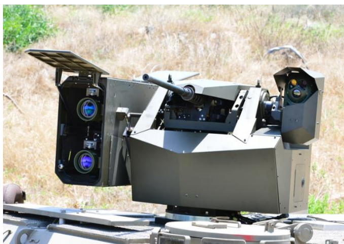
圖九：Samson Mini RWS 微型遙控槍塔
