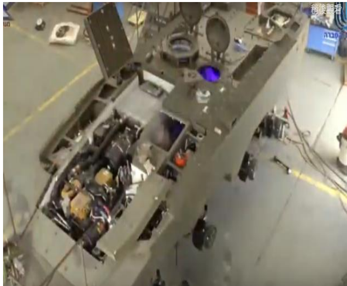
圖七：埃坦八輪甲車動力艙
