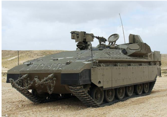
圖五：雌虎(Namer)重型裝甲人員運輸車
