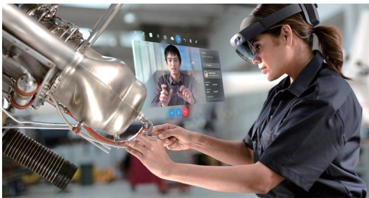
圖九 發動機技術人員使用微軟（Microsoft）公司Hololens頭戴式AR耳機麥克風進行發動機維修作業，並與高階技術指導員互動 24
