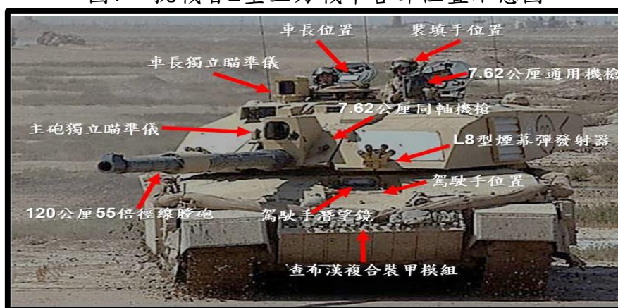
圖7、挑戰者2型主力戰車各部位位置示意圖
