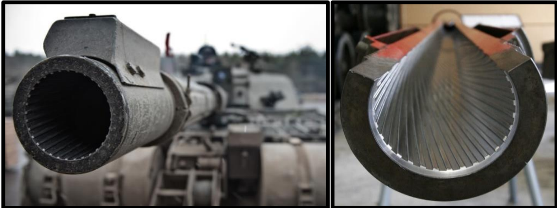
圖8、L-30A1型120公釐55倍徑線膛砲
