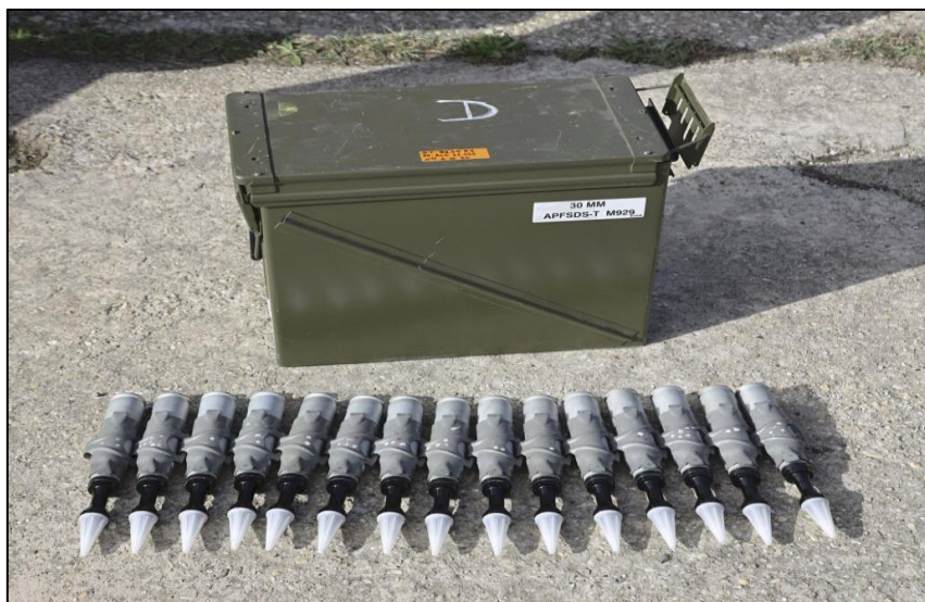
圖 9、2A42 所使用之 30*165 公釐翼穩脫殼穿甲彈
