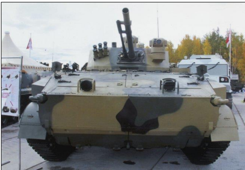
圖 17、裝有無人砲塔的實驗型 BMP-3 步兵戰鬥車
