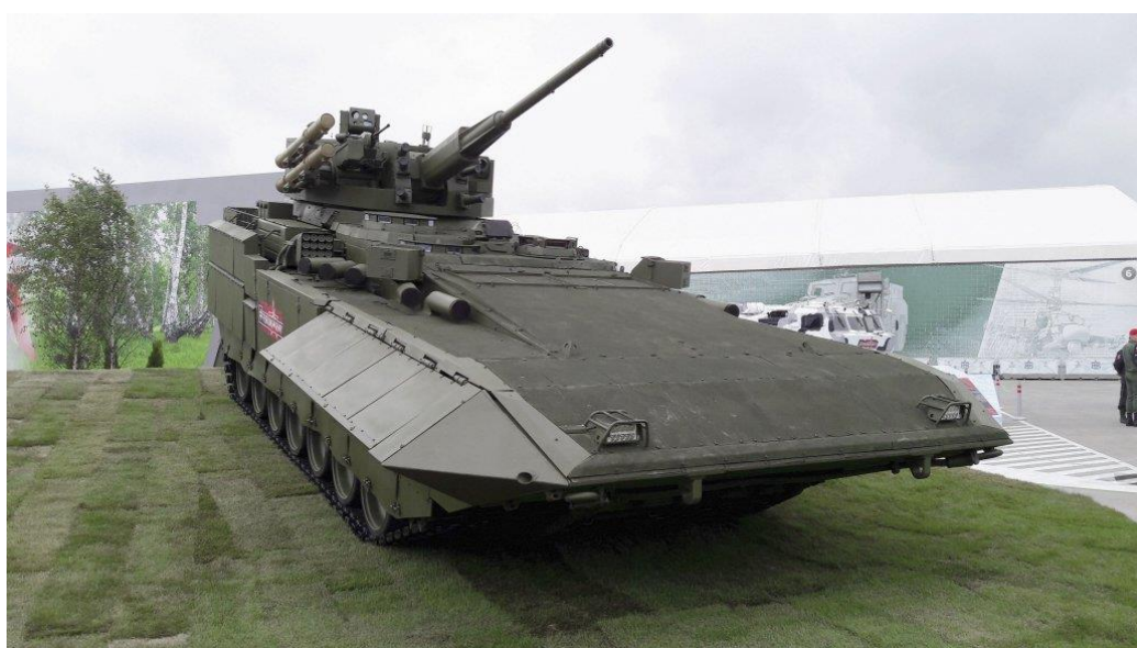
圖 18、配備主動式防護系統之俄羅斯 T-15 步兵戰鬥車
