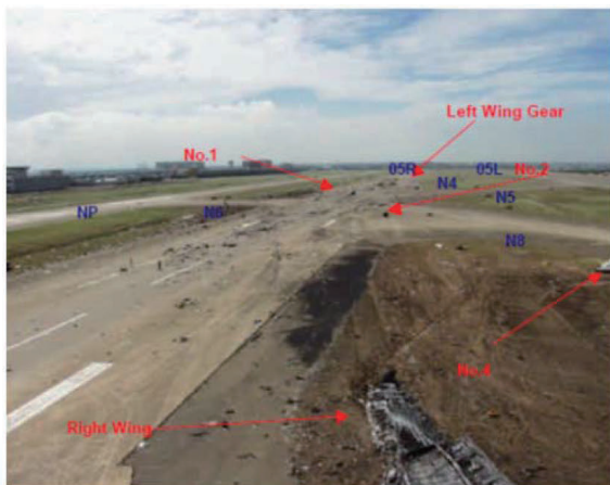
圖8 SQ006滾行方向相反殘骸分布圖
