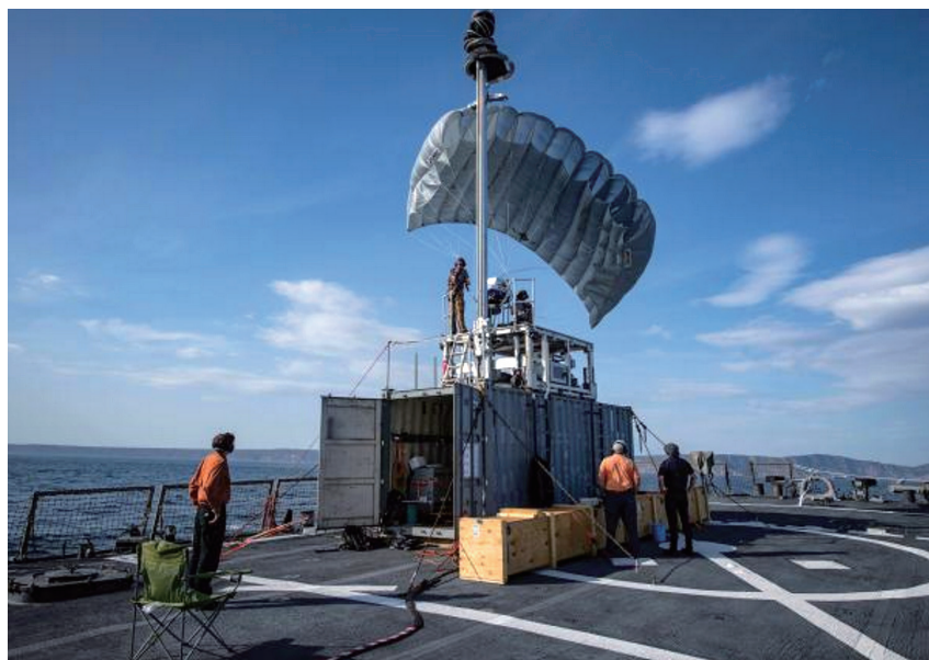
拖曳式海軍系統是一種可經由水面載具拖曳升空，並可攜帶各式感測器的輕型滑翔傘，以提升狀況覺知能力。(Source: USN/Logan Keown)
