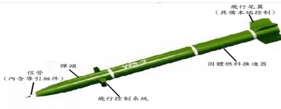
圖八 衛士-2D 火箭彈構造
