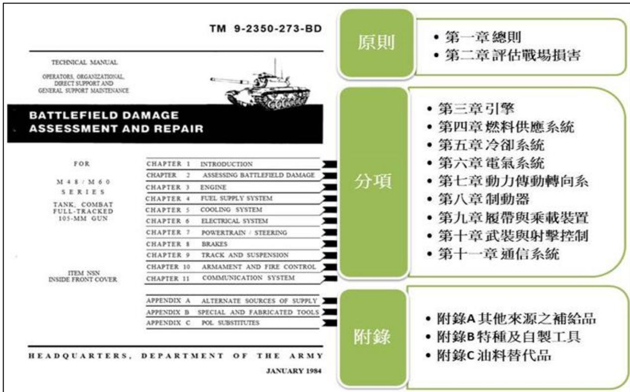
圖四 美陸軍 M48/M60 系列主戰車「戰場損壞評估修復」技術手冊內容架構圖
