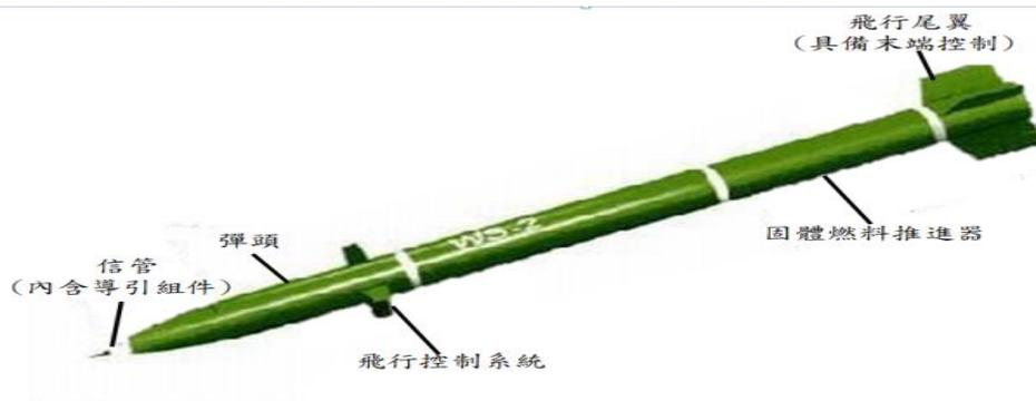
圖八 衛士-2D 火箭彈構造
