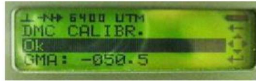
圖十 內建計算磁針方格偏差角
