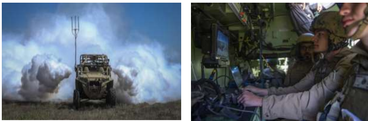
圖 19 美軍在多功能載具安裝 SOM 並在 1 公里外 Stryker 上進行遠端操控
