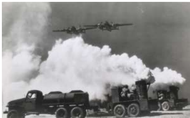
圖 11 車載 M1 發煙器施放煙幕 圖 12 M2 發煙器施放煙幕
