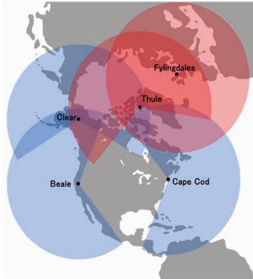
圖4 美國空軍「鋪路爪」(PAVE PAWS)預警雷達與「彈道飛彈預警系統」(BMEWS)偵測涵蓋圖，現已升級為「固態相位陣列雷達系統」(SSPARS)，正式名稱為「升級版預警雷達」(UEWR)。
