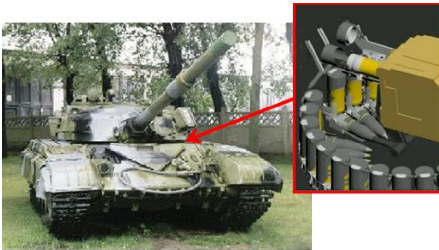
圖 7、砲塔內戰車砲擺放示意圖
