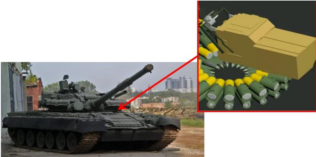
圖 12、圓形輸送帶從砲塔地板下的彈倉供彈
