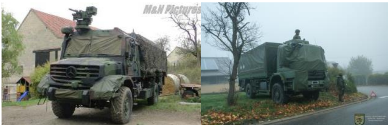
圖廿一及廿二 以帆布遮蔽車窗及燈系遂行光源管制
