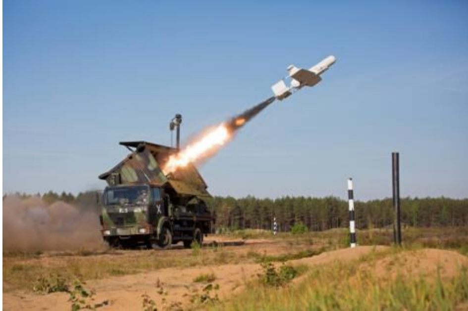
圖九 KZO 以火箭助推器發射起飛
