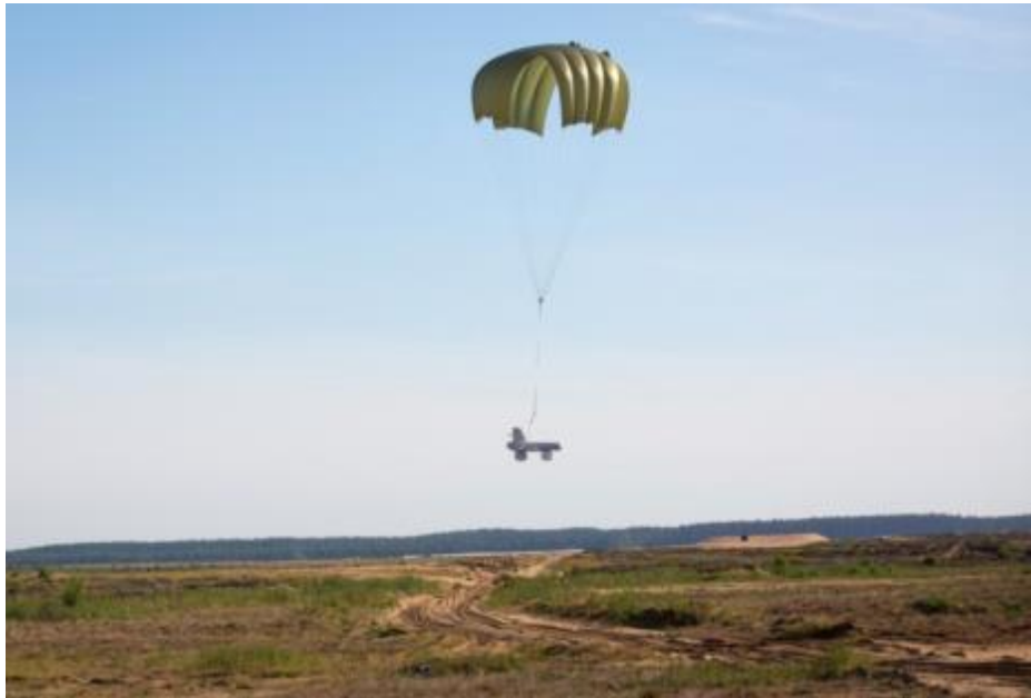
圖十 KZO 以降落傘實施降落回收
