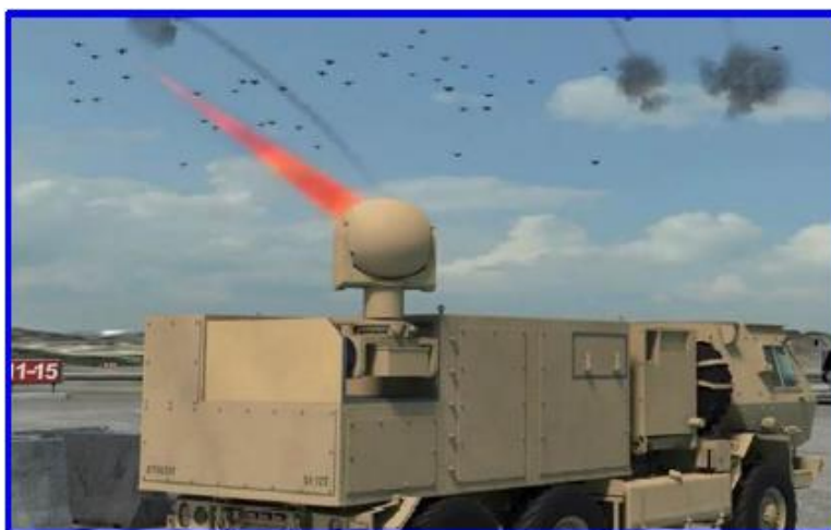
圖二十八 美軍反無人機第五層防空網 - 高能雷射戰術輪車 (HEL - TVD)
