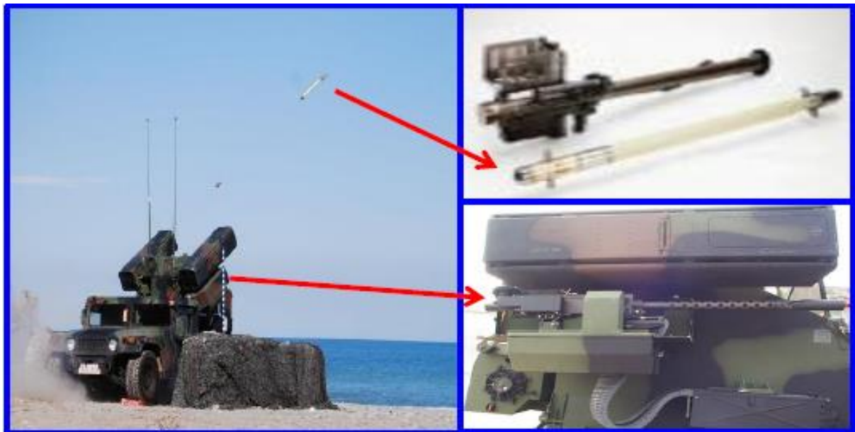
圖二十二 復仇者飛彈系統（刺針飛彈與 M3P 五〇機槍）
