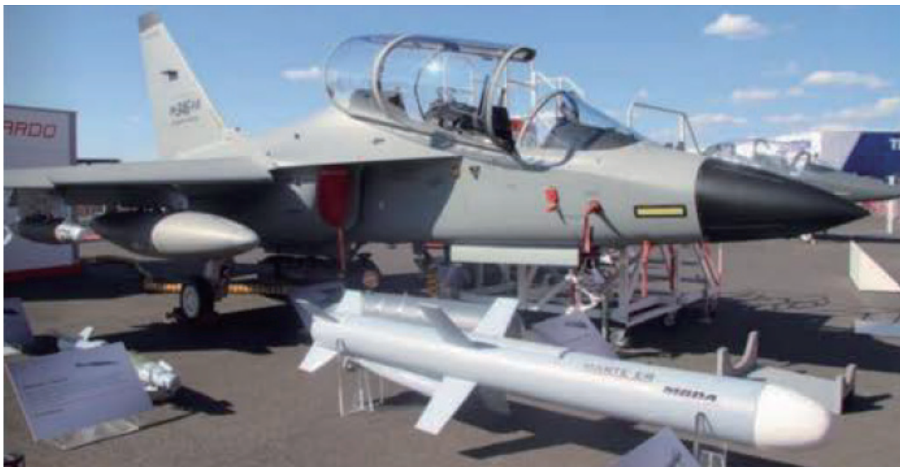
李奧納多公司供售整合雷達、先進航電與武器、可遂行戰機與攻擊機任務的M-346FA型機。(Source: Alan Warnes)
