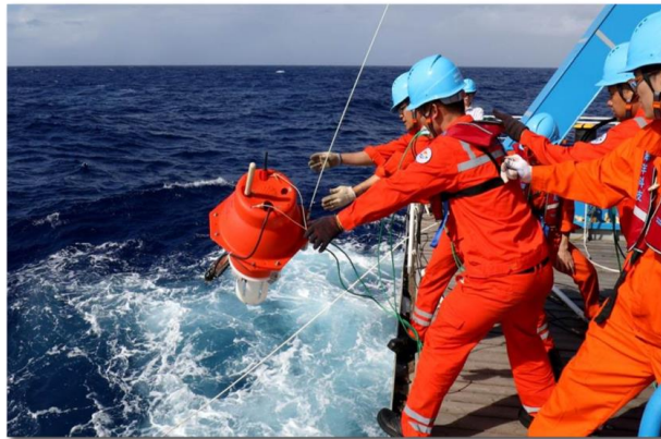
圖二 「沈括」號考察隊員施放 4500 公尺級大深度剖面浮標
