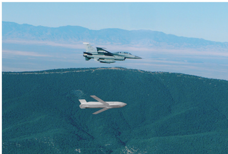
圖六 由F-16D測評機投放的「聯合空對地／海防區外擴展射程飛彈」(JASSM-ER)畫面，目的在取代現役的AGM-84「魚叉」系列反艦飛彈。
