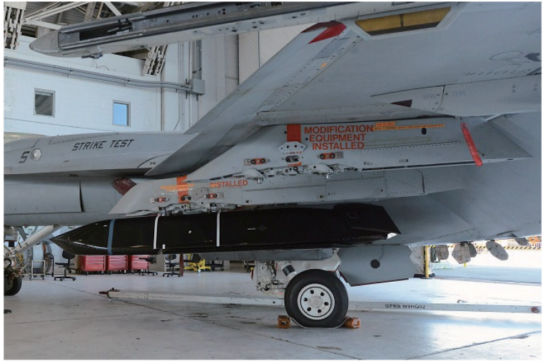
圖五 搭載於海軍第23測評隊(VX 23)F/A-18E機翼派龍的AGM-158C LRASM(Long Range Anti-Ship Missile)長程反艦飛彈。
