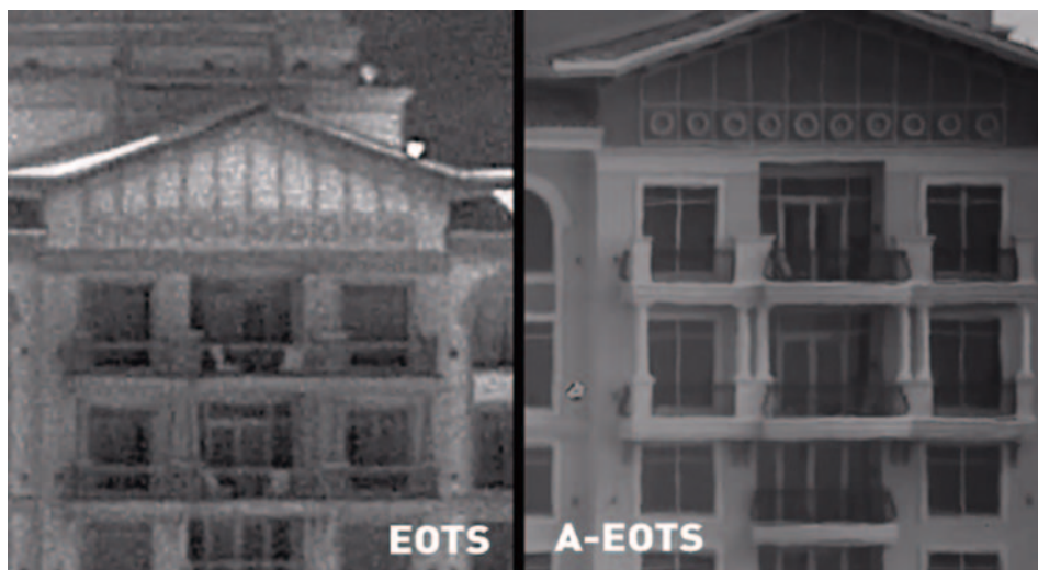
圖17：EOTS(左)與AEOTS(右)對同一目標的影像對比。Lockheed Martin
