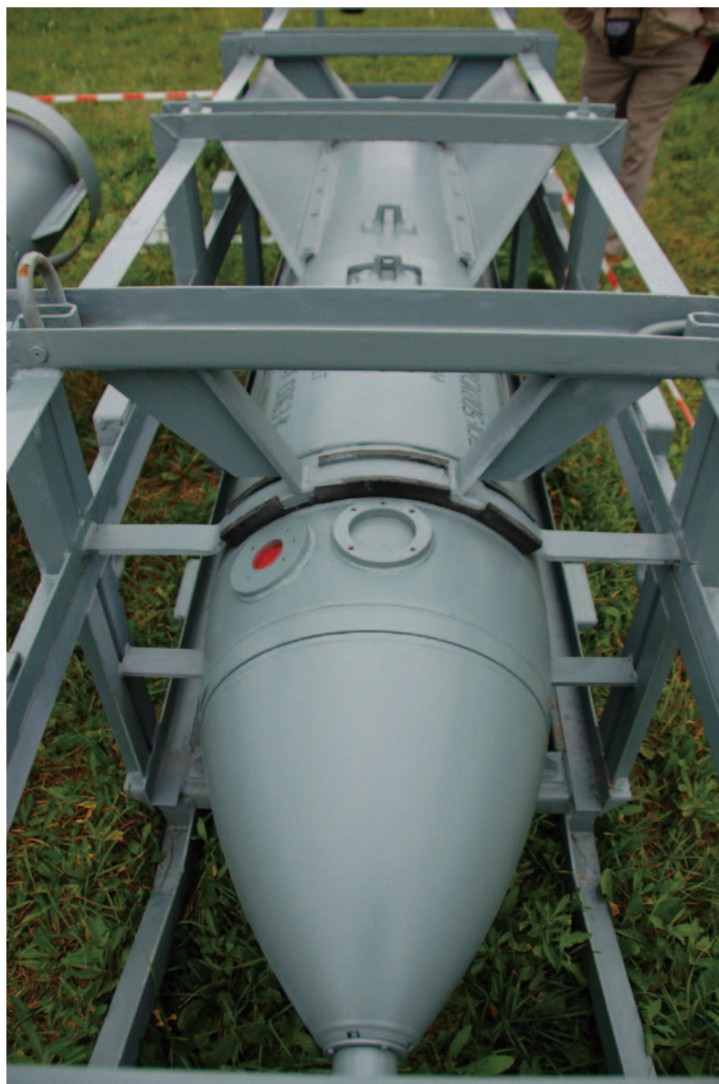
圖7：Su-35的新一代無動力彈藥往往加裝滑翔翼以延長射程，圖為PBK-500U集束炸彈，在RBK-500的基礎上加裝滑翔翼而來，最大射程達50km。(作者攝)
