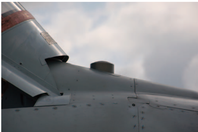
圖12：MiG-35原型機的OAR-U，採用魚眼鏡頭，直接凝視半個球面，此設計與Rafale的SPECTRA類似。(作者攝)
