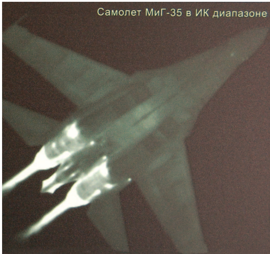
圖9：以天空為背景時，背景的热影像通常都比飛機還暗，故不需反白處理也能清楚識別。NII PP
