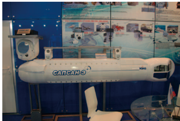
圖5：UOMZ發展的Sapsan-E瞄準莢艙。2000年代，在歐美莢艙已普遍具有熱影像儀的時候，其仍只有電視攝影機與雷射測距機。瞄準莢艙確實是俄國的軟肋。(作者攝)
