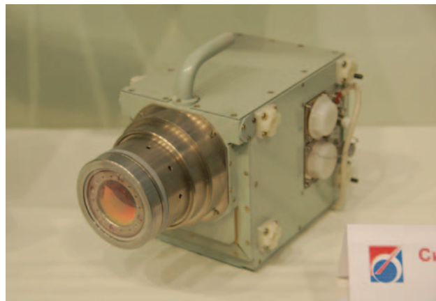
圖13：Su-35S用6個OAR熱影像儀構成球狀視野，用途相當於每F-35的EODAS，但體型約只有後者的一半。新的MiG-35也採用此設計。(作者攝)
