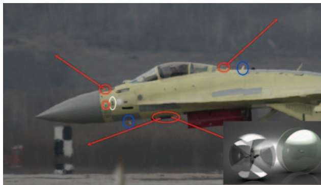
圖10：SOER的6個OAR(紅色圈選處)與2個OLO(白色圈選處)構成球狀熱影像與雷射視野。sukhoi
