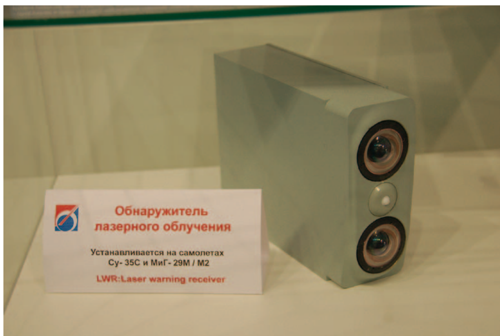
圖14：OLO雷射警告器特寫。在MiG-35上裝與主翼翼梢，在Su-35S上裝與機首兩側。(作者攝)
