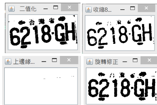
圖15.車牌傾斜修正過程
