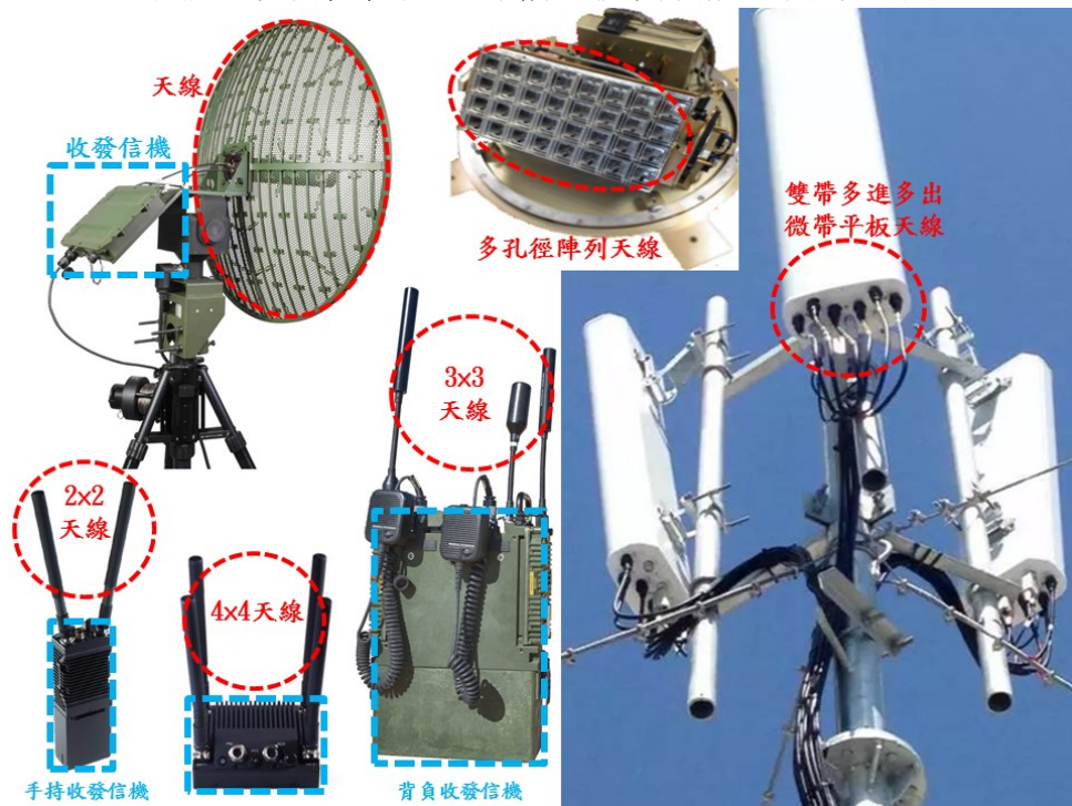
圖八 收發信機與天線構型技術發展趨勢示意圖
