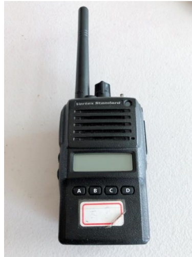
圖二 Vertex Standard VX- 820 無線電機
