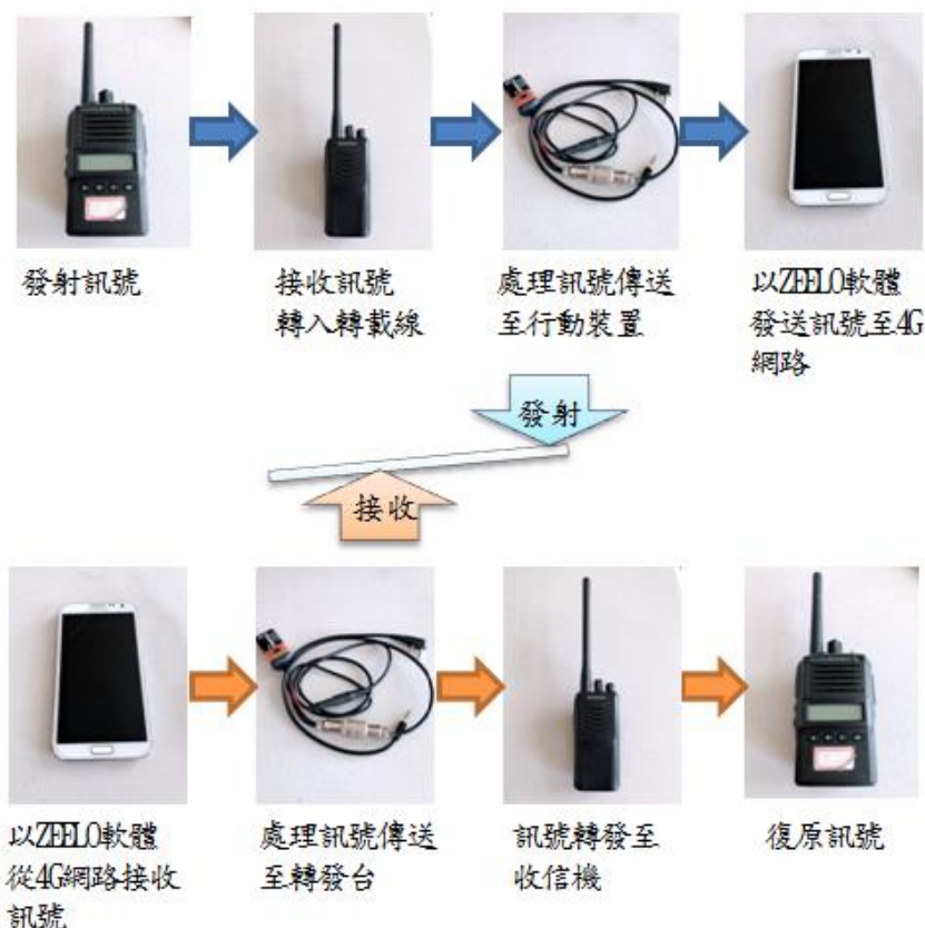
圖七 無線電發射與接收流程圖
