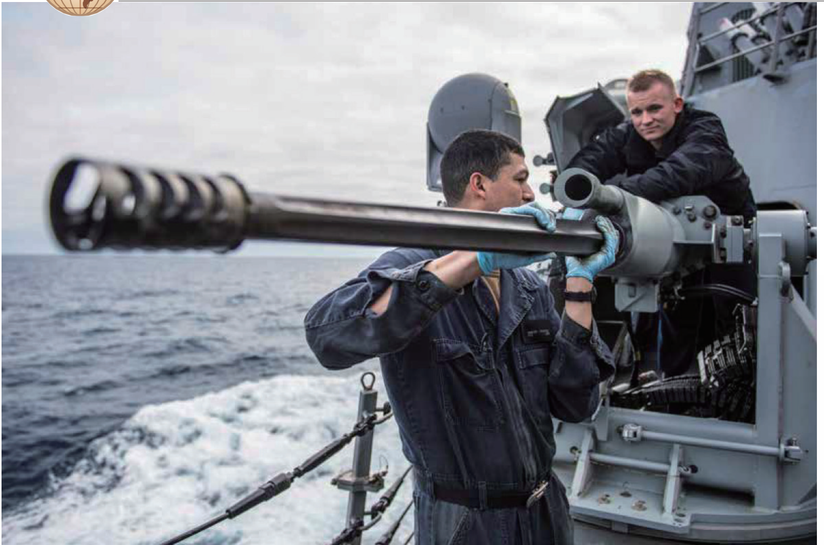
2019年3月5日，美軍艦波特號(USS Porter )驅逐艦航行於大西洋上，射控(左)與槍砲士官正在保養Mark 38型25公釐機槍。(Source: USN/James R. Turner)
