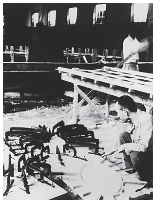
林炎星老師正仔細檢視機身段面與升降舵面結構的精確度。
