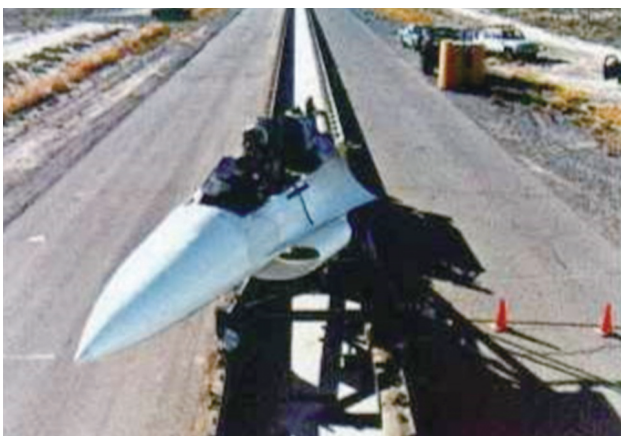
圖七：在美國霍洛曼基地F-16模型試驗的K-36D，側滑角20度。NPP Zvezda
