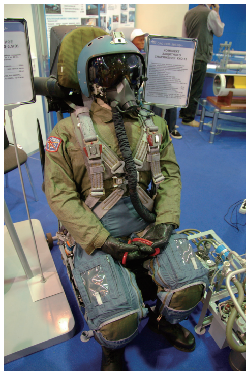
圖八：K-36D-3.5E。圖中可見頭靠比基本型K-36DM-2還小。作者攝
