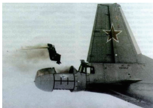
圖四：在俄國An-12實驗機上測試的K-36D-3點5A。 NPP Zvezda
