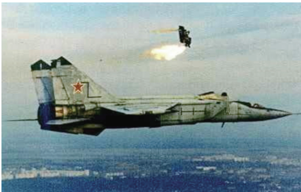
圖五：在俄國MiG-25試驗機上測試的K-36D-3點5A。NPP Zvezda
