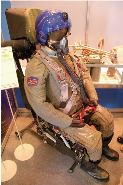
圖九：K-36D-5彈射椅與飛行員裝具。彈射椅背下方末端可見到火箭噴嘴，下方白色槓桿則是椅背調整機構。作者攝
