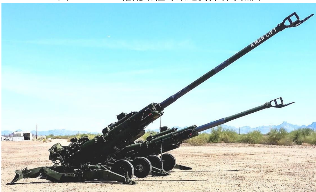
圖四 M777 39 倍徑與 58 倍徑砲管比較圖
