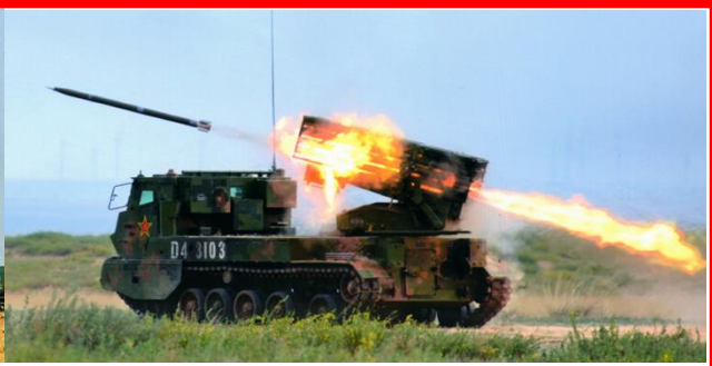
PHZ-10式122公厘40管履帶型多管火箭
