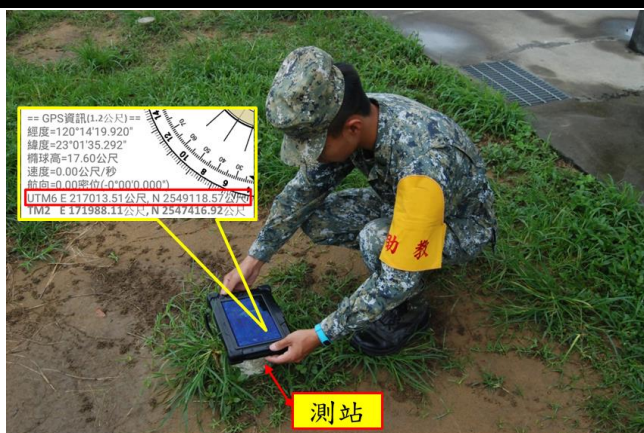
圖六 運用電算機實施「定位」作業
