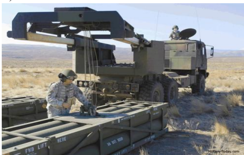
圖十 HIMARS 多管火箭系統彈藥裝卸載 資料來源 https://ss0.bdstatic.com/.jpg
