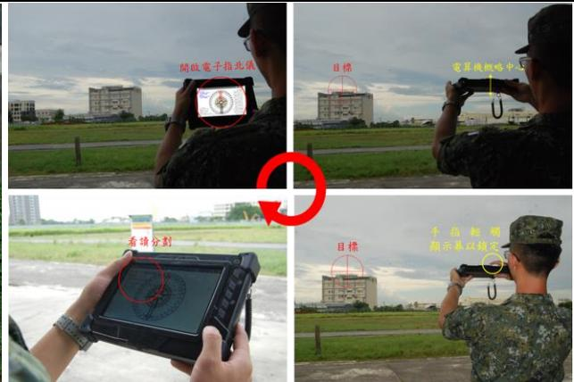
圖七 運用電算機實施「定向」作業
