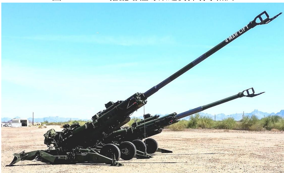
圖四 M777 39 倍徑與 58 倍徑砲管比較圖
