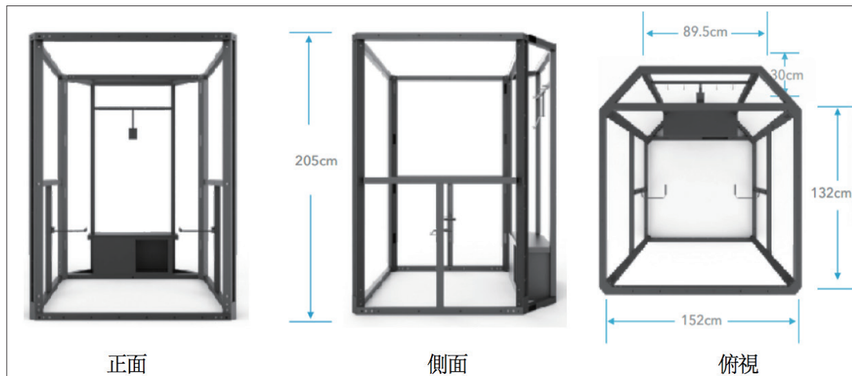
圖一 TG3D Scanatic 360 人體掃描機尺寸規格
