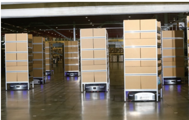
圖二 無人搬運車AGV在倉庫中穿梭
