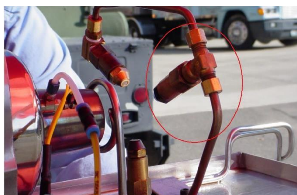
圖 10 使用銅管和 Swagelok T 設計大於排氣直徑的環
