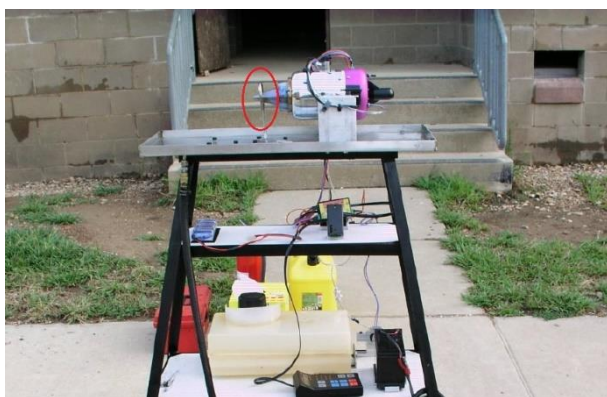
圖 9 直接在渦輪引擎排氣尾管後安裝噴霧器
