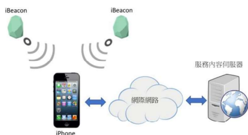
圖 3. iBeacon 運作原理示意圖
