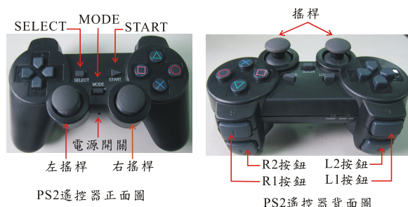
圖三十：PS2 遙控器多通道控制實驗-按鈕顯示
