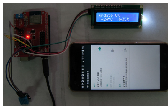
圖二十六：ESP8266 模組無線資料傳輸實驗呈現的溫溼度接收結果
