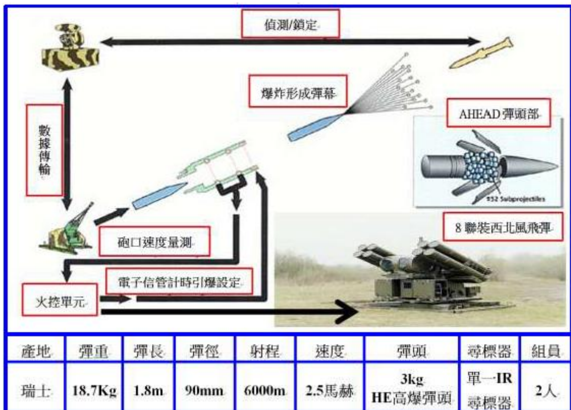
圖十一 義大利艾達特斯（ADATS）彈砲整合防空系統與諸元
